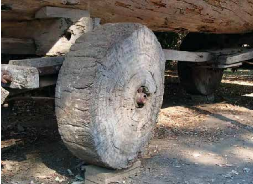
Scheibenräder sind die älteste Form des Rads. Um 3500 vor Christus entstand im Alpenvorland das älteste bekannte Rad aus massivem Ahornholz.
